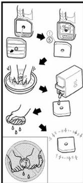
De temps en temps, le filtre à air doit être vérifié pour la contamination. Un entretien régulier du filtre à air est nécessaire pour maintenir un débit d'air suffisant dans le carburateur.
